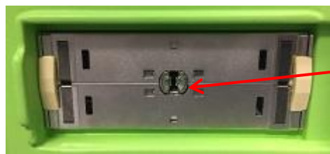
Figura 20: Entalhe de bloqueio na ranhura do conector do transdutor
