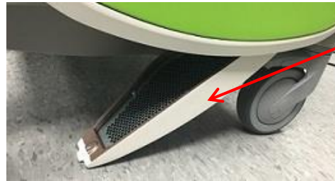
Figura 69: Acesso ao filtro de ar inferior
